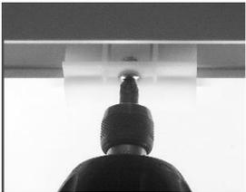
Verschrauben Sie die 14 mitgelieferten Befestigungswinkel von Innen an den Schraubdomen des Oberrahmens. Ziehen Sie die Schrauben soweit an, bis die Winkel leicht zu kippen anfangen.
