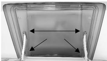
Zum Reinigen kann die Haube durch Entfernen der Kunststoffsplinte abgenommen werden. Beachten Sie, dass die Kunststoffsplinte dabei beschädigt werden können und ggf. ersetzt werden müssen.
