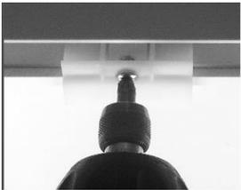
Verschrauben Sie die 14 mitgelieferten Befestigungswinkel von Innen an den Schraubdomen des Oberrahmens. Ziehen Sie die Schrauben (über Kreuz) soweit an, bis die Winkel leicht zu kippen anfangen.
