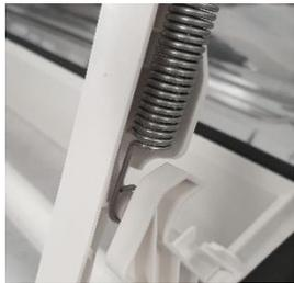
Fixieren Sie die Feder mit dem Federsplint an der Glashaube.
