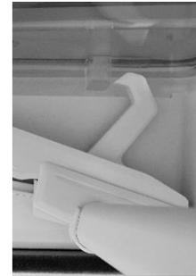
Fassen Sie die Querstange mittig und drehen Sie diese, sodass sich die Verriegelung löst.
