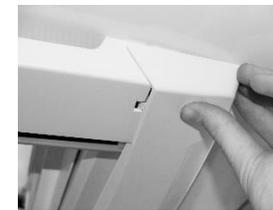
Setzen Sie die seitliche Abdeckung jeweils parallel zum Dach an, sodass die Rastnasen in die vorgesehenen Löcher am Rahmen eintauchen. Schieben Sie die Abdeckung in Richtung des Rahmens, bis sie hörbar einrastet.
